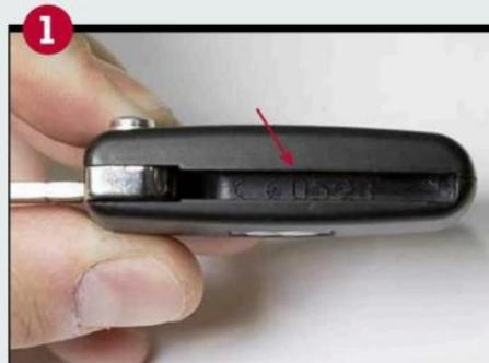
**1 Relevez la référence.** Inscrite dans le logement de la lame, elle varie d'une coque à l'autre, y compris chez le même constructeur. Derrière cette inscription se cachent plusieurs caractéristiques : forme intérieure en fonction de l'emplacement de la pile, largeur de l'insert (de 7 à 8 mm)...
