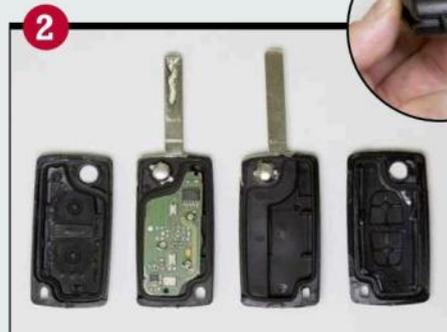
**2 Ouvrez avec soin.** Les demi-coques sont assemblées par des clips de fixation qu'il ne faut pas casser. A réception du nouveau boîtier, essayez-vous sur l'ancien en passant un petit tournevis au niveau de l'encoche. Tournez-le pour créer un espace plus important et faites levier.
