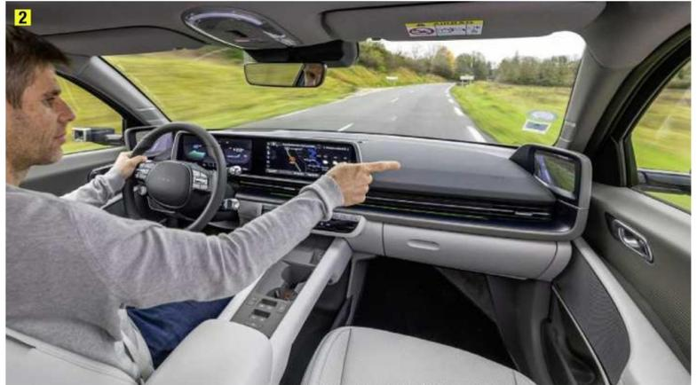
**Plus compact qu'un modèle classique, un rétroviseur caméra 1 et 2 se montre plus aérodynamique, au bénéfice de la consommation... même si les gains restent anecdotiques.**
